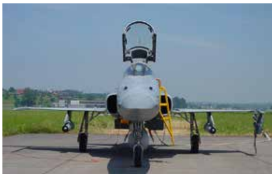
Figur 1 : Höhenluftfilter-Aggregate montiert an den beiden Flügeln eines Tiger.
