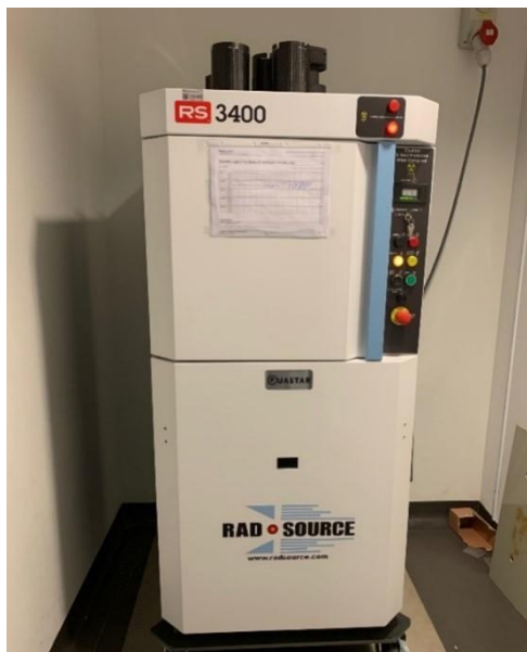
Figura 2: Esportazione di un impianto di irradiazione del sangue al cesio (a sinistra). L'apparecchio con sorgenti ad alta attività, del peso di diverse tonnellate, viene sistemato nel contenitore per il trasporto. Lo smaltimento costa attualmente circa centomila franchi, con tendenza all'aumento. A destra è raffigurata un'apparecchiatura per l'irradiazione equivalente installata come alternativa a quella al cesio. Visto che non rappresenta nessun pericolo di uso illecito, questa apparecchiatura non necessita di un'ulteriore difesa contro il furto e il sabotaggio; inoltre anche lo smaltimento sarà notevolmente più conveniente.
