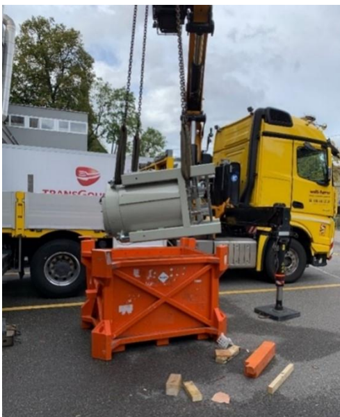
Figura 2: Esportazione di un impianto di irradiazione del sangue al cesio (a sinistra). L'apparecchio con sorgenti ad alta attività, del peso di diverse tonnellate, viene sistemato nel contenitore per il trasporto. Lo smaltimento costa attualmente circa centomila franchi, con tendenza all'aumento. A destra è raffigurata un'apparecchiatura per l'irradiazione equivalente installata come alternativa a quella al cesio. Visto che non rappresenta nessun pericolo di uso illecito, questa apparecchiatura non necessita di un'ulteriore difesa contro il furto e il sabotaggio; inoltre anche lo smaltimento sarà notevolmente più conveniente.
